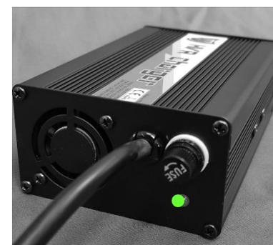
Si la LED jaune sur la moto et la LED verte s'allument sur le chargeur, cela signifie que la batterie est trop chaude ou trop froide pour charger. Si la batterie refroidit dans l'heure à venir, le chargement commencera automatiquement. Si la batterie est trop froide, amenez la moto à un endroit plus chaud et redémarrez le processus de charge lorsque la batterie est assez chaude.
