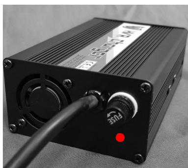
La batterie est chargée, de plus en plus de LED vertes (la dernière clignote) en fonction du SOC (état de charge) s'allument progressivement. Sur le chargeur, la LED s'allume en rouge.
