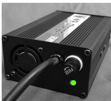
La batterie est entièrement chargée. 60 secondes après, la moto s'éteint et les LED vertes s'éteignent sur la moto. Sur le chargeur, la LED s'allume en vert.
